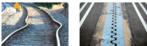
(a) 因热膨胀而损毁的铁轨
