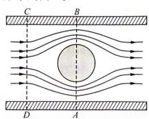
7. <mark>连续性方程式</mark>表明,流体流过任一截面 的流量相等,其流速与管道的横截面积 成反比。(适用于稳定流动的理想流体)
