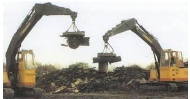
电磁铁的应用很广，如电磁门锁、电铃、电磁铁起重机等。
